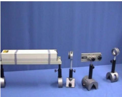
„Da es sich bei einer Kerze jedoch um eine thermische Lichtquelle handelt, muss der Versuch um Interferenzen beobachten zu können mit einem Laser durchgeführt werden.“
