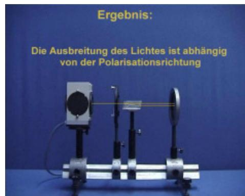
„Die Ausbreitung des Lichtes ist abhängig von der Polarisationsrichtung.“
