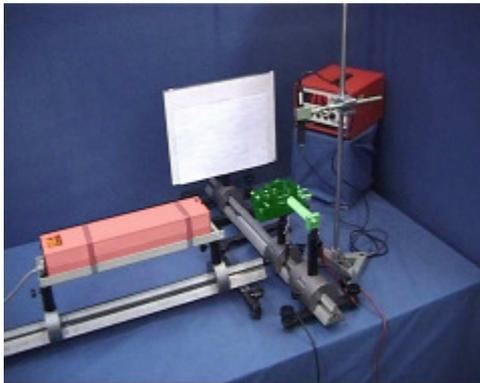
„Ein Laser strahlt in ein Michelson-Interferometer.“
