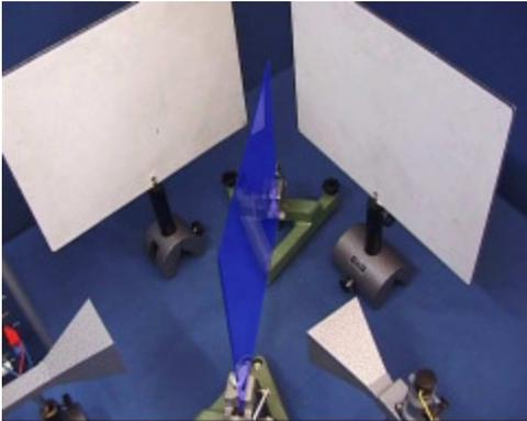
„Dazu verwenden wir eine Glasplatte als Strahlteiler,...“
