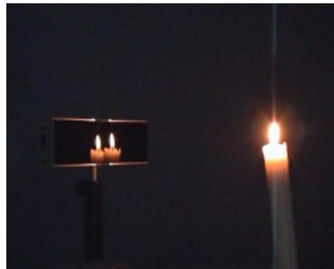
„Die beiden hier gezeigten Kerzen sind virtuell und werden durch einen Fresnelschen Spiegel erzeugt.“
