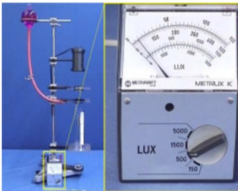
„Das Messgerät zeigt die Lichtstärke in Lux an.“
