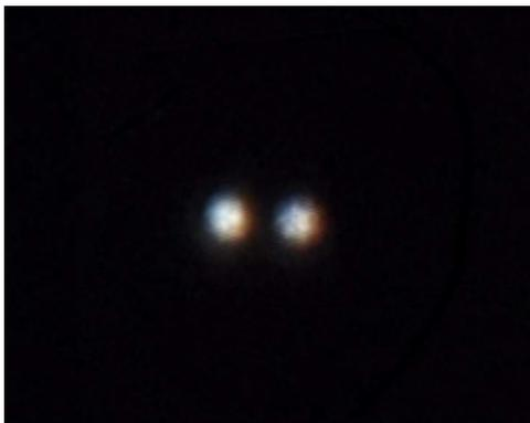
„Wir betrachten zur Untersuchung dieses Kriteriums zwei quasi-punktförmige Lichtquellen durch ein Teleskop. Wird die Auflösungsgrenze durch Verkleinern der Apertur unterschritten, erwarten wir ein ‚Verschmieren‘ der Lichtpunkte.“
