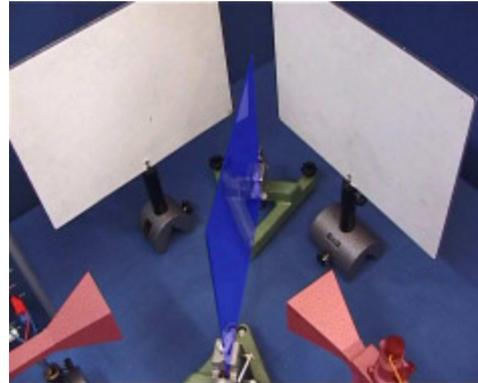
„... einen Mikrowellensender, einen Empfänger dessen Signal verstärkt und auf einen Lautsprecher gegeben wird, und zwei Metallplatten als Reflektoren.“
