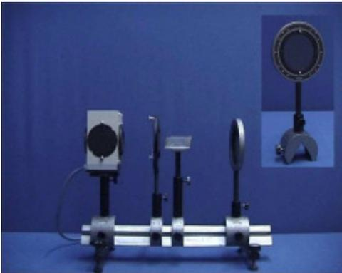
„...sowie einen Polarisationsfilter als Analysator für das durch den Kristall fallende Licht.“
