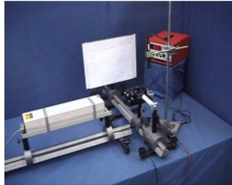
„Um eine Längenänderung mit Hilfe der Interferometrie zu messen benutzen wir diesen Aufbau:“
