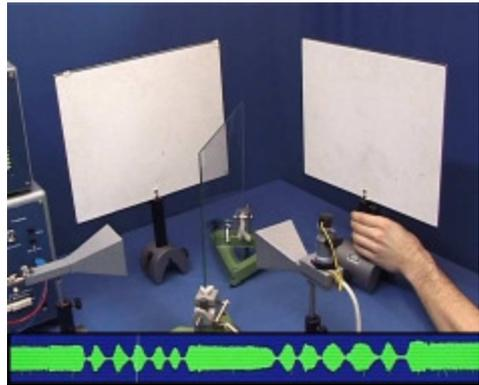
„Durch Variieren des Wegunterschiedes, können wir konstruktive und destruktive Interferenz beobachten.“
