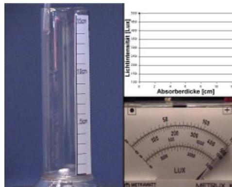
„Im Versuch sehen wir nun das sich füllende Becherglas, die Anzeige des Messgerätes sowie ein Diagramm, in das die zu durchlaufende Strecke gegen die transmittierte Lichtintensität aufgetragen werden.“
