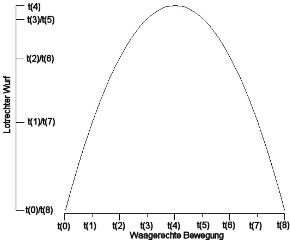
Der Körper möge nun mit der Anfangsgeschwindigkeit  $v_0$  unter dem Wurfwinkel  $\alpha$  (gegenüber der Horizontalen) abgeworfen werden. In Richtung der x-Achse liegt eine Bewegung mit konstanter Geschwindigkeit vor:
