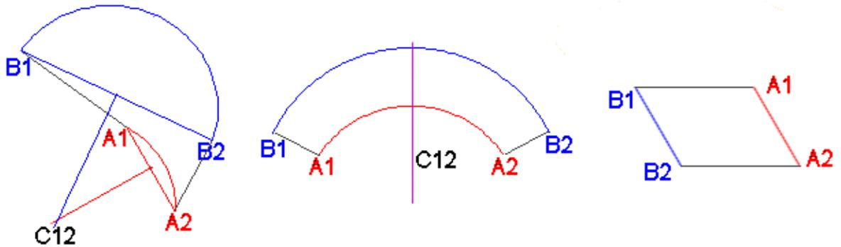
Die Existenz eines Drehzentrums ist also in jedem Fall gesichert! Dadurch erhalten wir den Fundamentalsatz der ebenen Kinematik:
