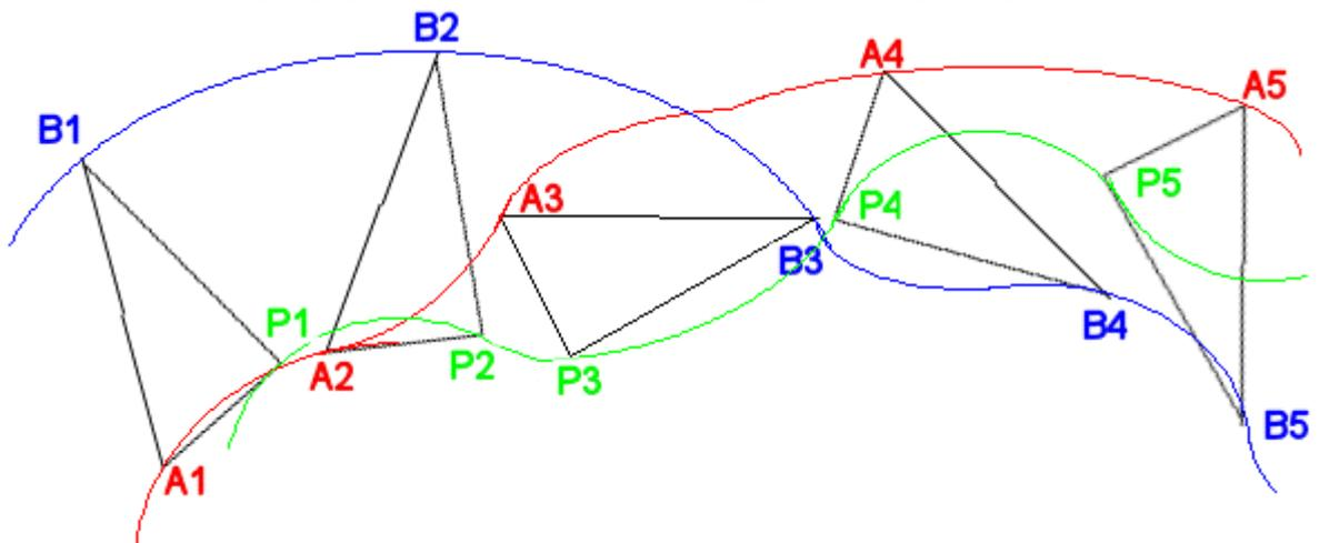
Vergleicht man nun zwei dicht aufeinanderfolgende Lagen  $A_1$  und  $A_2$  bzw.  $B_1$  und  $B_2$  auf den dazugehörigen Bahnkurven, so stellt man fest, dass die dazugehörigen Kurvenbögen  $A_1A_2$  und  $B_1B_2$  unterschiedlich lang sind. Die Bahnen also mit unterschiedlicher Geschwindigkeit durchlaufen werden.
