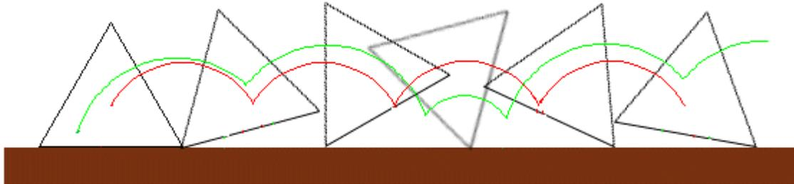
**Bahnkurve zweier beliebiger Punkte eines gleichseitigen Dreiecks**
